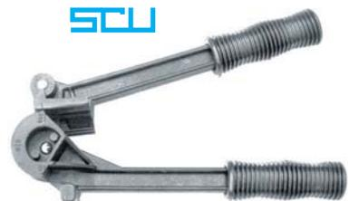
Tipo in fibra di vetro, infrangibile. Per curvare da 0° a 180° tubi di alluminio, ottone, rame ricotto e acciaio sottile. Esegue curvature di tubi con quattro diametri diversi, senza intercambio di matrice.
