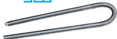
Per uso all'interno del tubo. In fili d'acciaio per molle. Con due anelli per estrazione. Per curvare a freddo tubi di rame ricotto. Lunghezza totale circa mm 1100.
